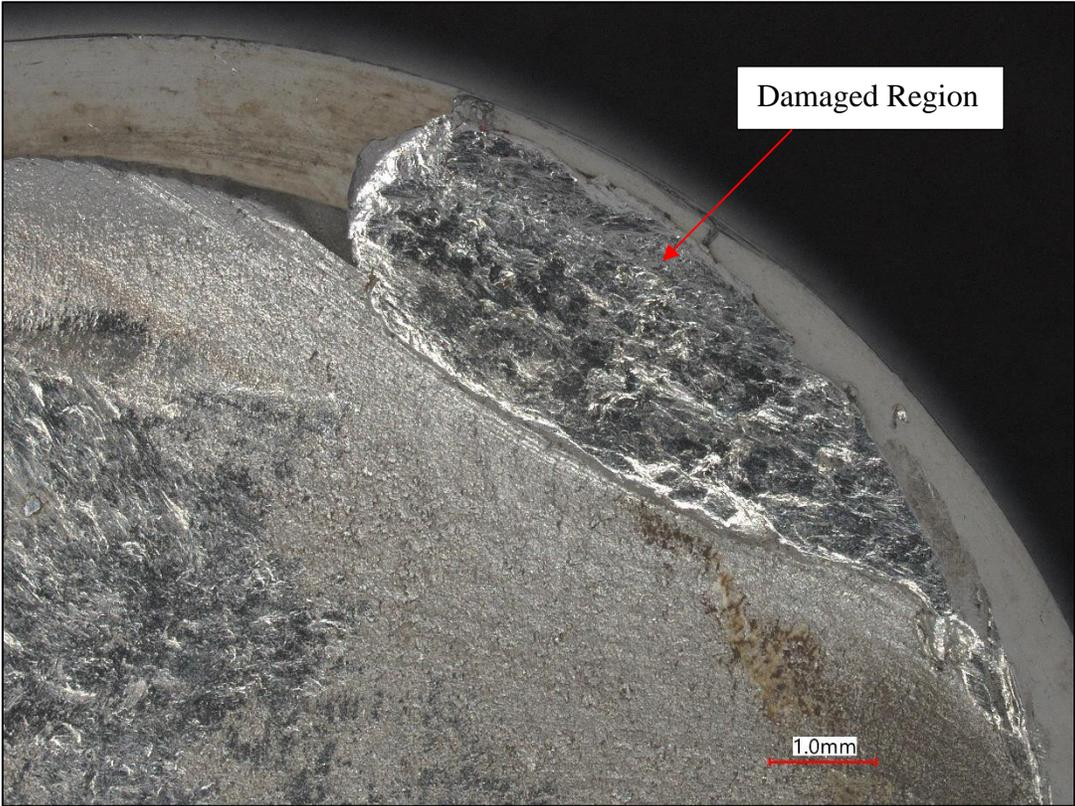
**FIGURE 22. BEACH MARKS AROUND 12 – 01 O'CLOCK, BOLT C2**
