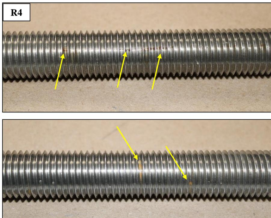
**FIGURE 18. PHOTOS SHOWING RUST STAINS ON BOLT R4.**
