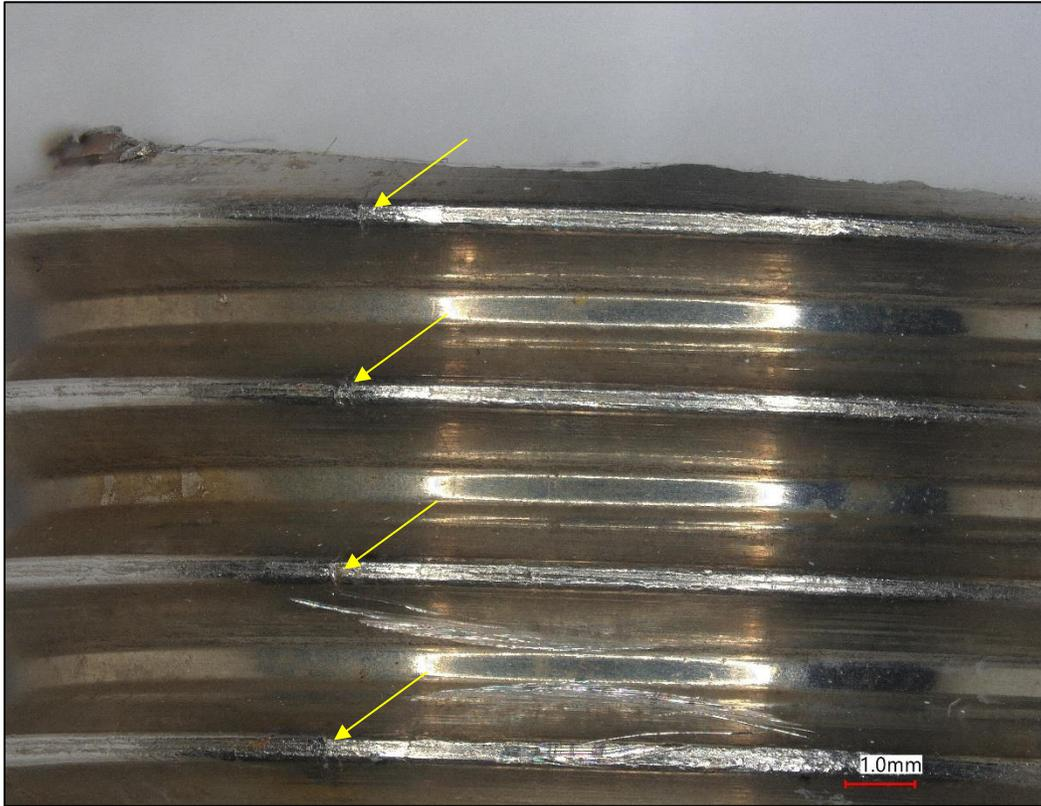
**FIGURE 29. CRACK LIKE LONGITUDINAL INDICATION ON THE THREADS, BOLT C5**
