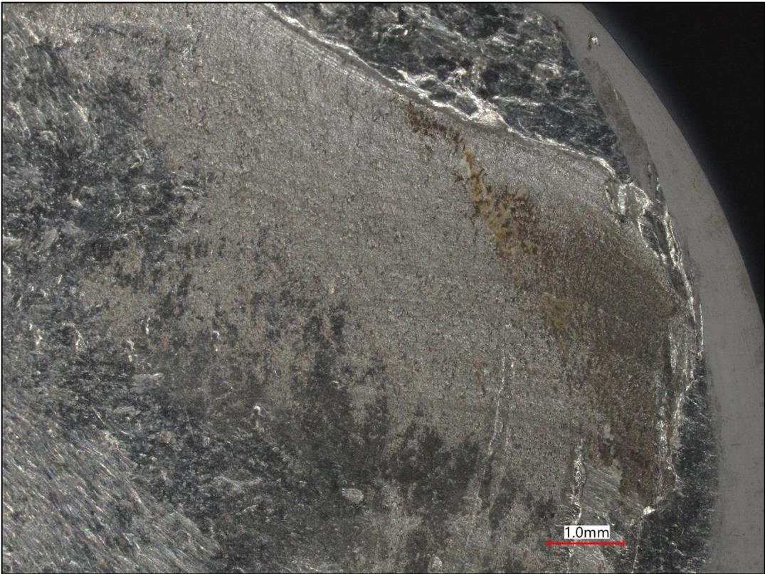
**FIGURE 23. BEACH MARKS AROUND 3 O'CLOCK, BOLT C2**
