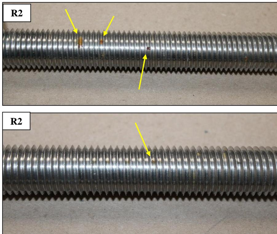
**FIGURE 17. PHOTOS SHOWING RUST STAINS ON BOLT R2.**
