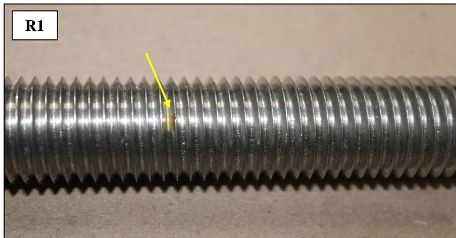
**FIGURE 16. PHOTO SHOWING RUST STAINS ON BOLT R1.**
