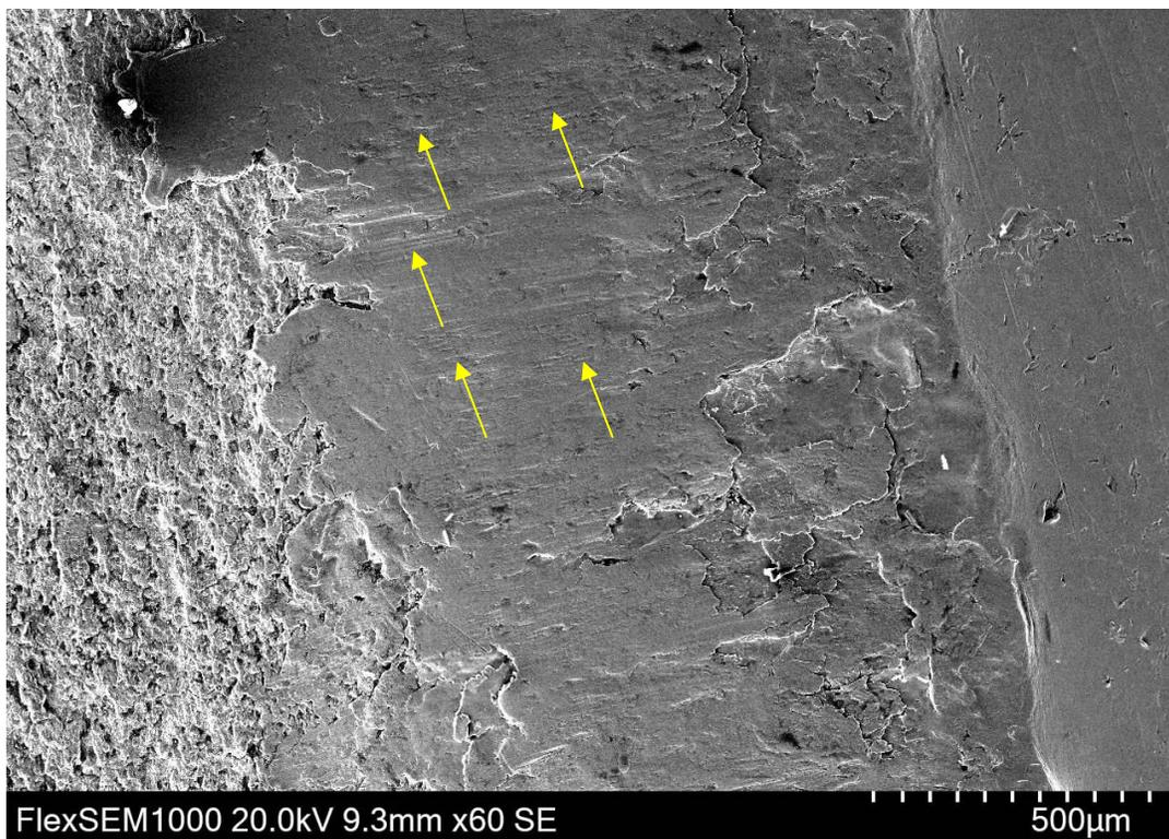
**FIGURE 35. VAGUE BEACH MARKS ON THE BURNISHED FRACTURE SURFACE. 12 – 02 O’CLOCK REGION, BOLT C2**
