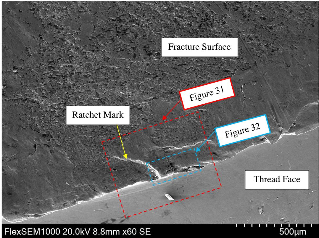
**FIGURE 30. FRACTURE SURFACE/THREAD FACE. 6 O’CLOCK BOLT C2**
